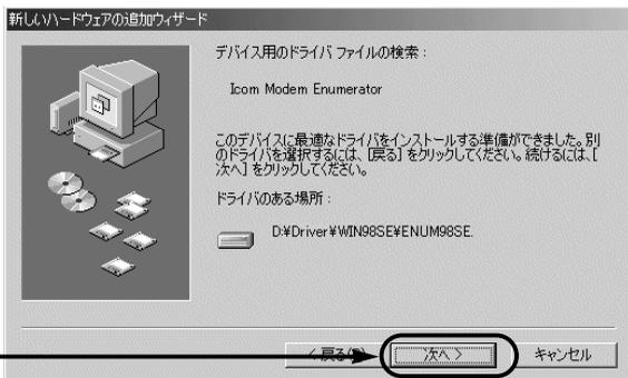
4.次の画面で 完了 をクリックすると、USBドライバーのインストールが完了します。
